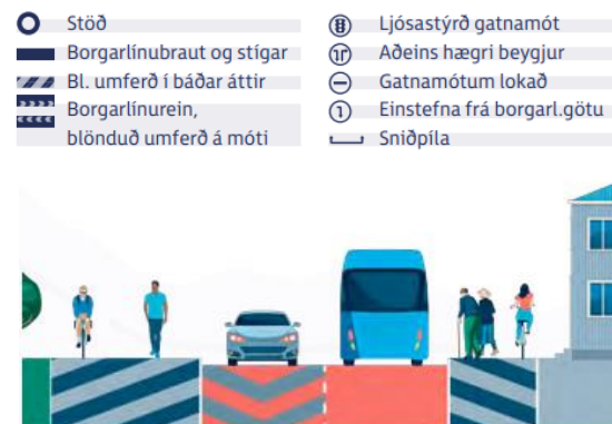
Mynd 2.2 Snið Borgarholtsbrautar milli Þinghólsbrautar og Urðarbrautar. Einstefna bílaumferðar er í götunni til vesturs (norðan megin). Gangstétt er breiðari norðan megin. Mynd úr Frumdragaskýrslu Borgarlínunnar.
