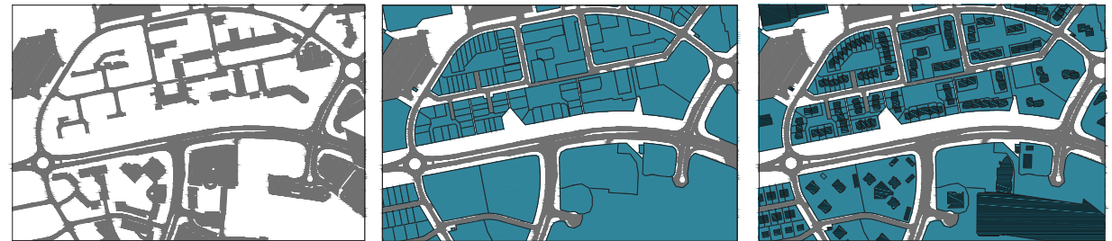
Grunneiningar skipulags eru götur, lóðir og hús samkvæmt þýska landfræðingnum M.R.G. Conzen sem hefur unnið við rannsóknir á borgarformfræði.
