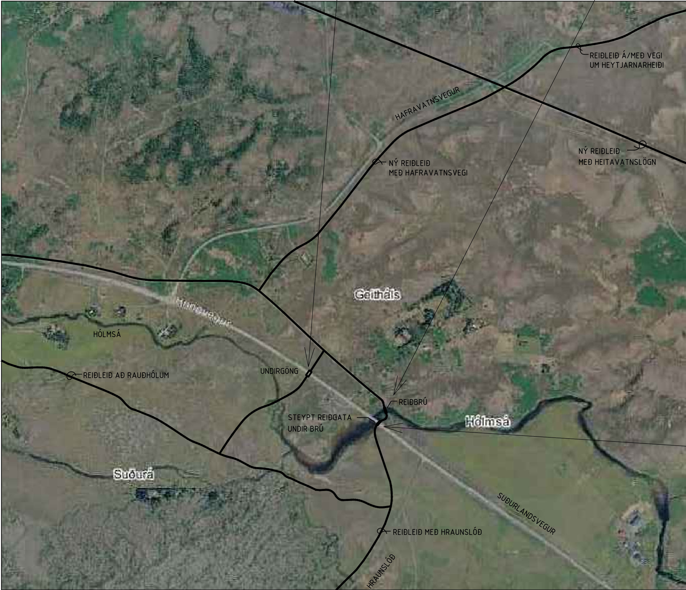
TIL VIÐMIÐUNAR REIÐGÖNG UNDIR SUBURLANDSVEG NEÐAN FJÁRBORGAR. STÆRÐ Á REIÐGÖNGUM breidd 5.8 m, hæð 4.3 m SAMKVÆMT REIÐVEGABÓK VR OG LH SKAL RÝMI Í REIÐGÖNGUM VERA MINNST breidd 3.0 m og hæð 3.0 m.
