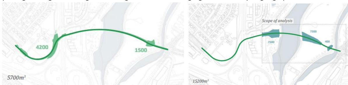
Mynd 4.4 Fyrirhugaður uppgroftur efnis (vinstri) og fylling efnis (hægri) miðað við valkost B.
