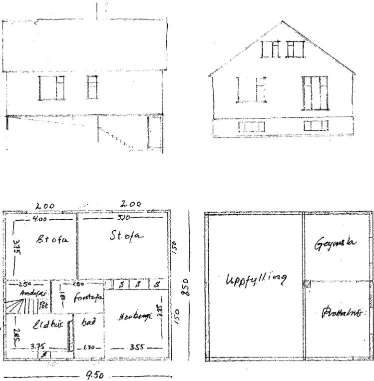
Mynd 23: Pinghólsbraut 65. Grunnmyndir og ásýndir, 1947.
