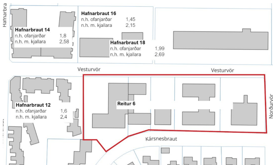
Mynd 2 Nýtingarhlutfall í samþykktu deiliskipulagi aðliggjandi lóða.
