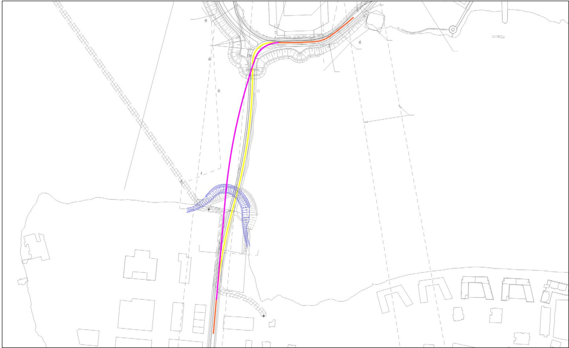
Lega Öldu í íhvolfum boga (gult) milli aðkomuvega (appelsínugult) í samanburði við ímyndaða kúpta veglínu (magenta). Grunnkort: Efla. Litaðar línur: VSÓ.
