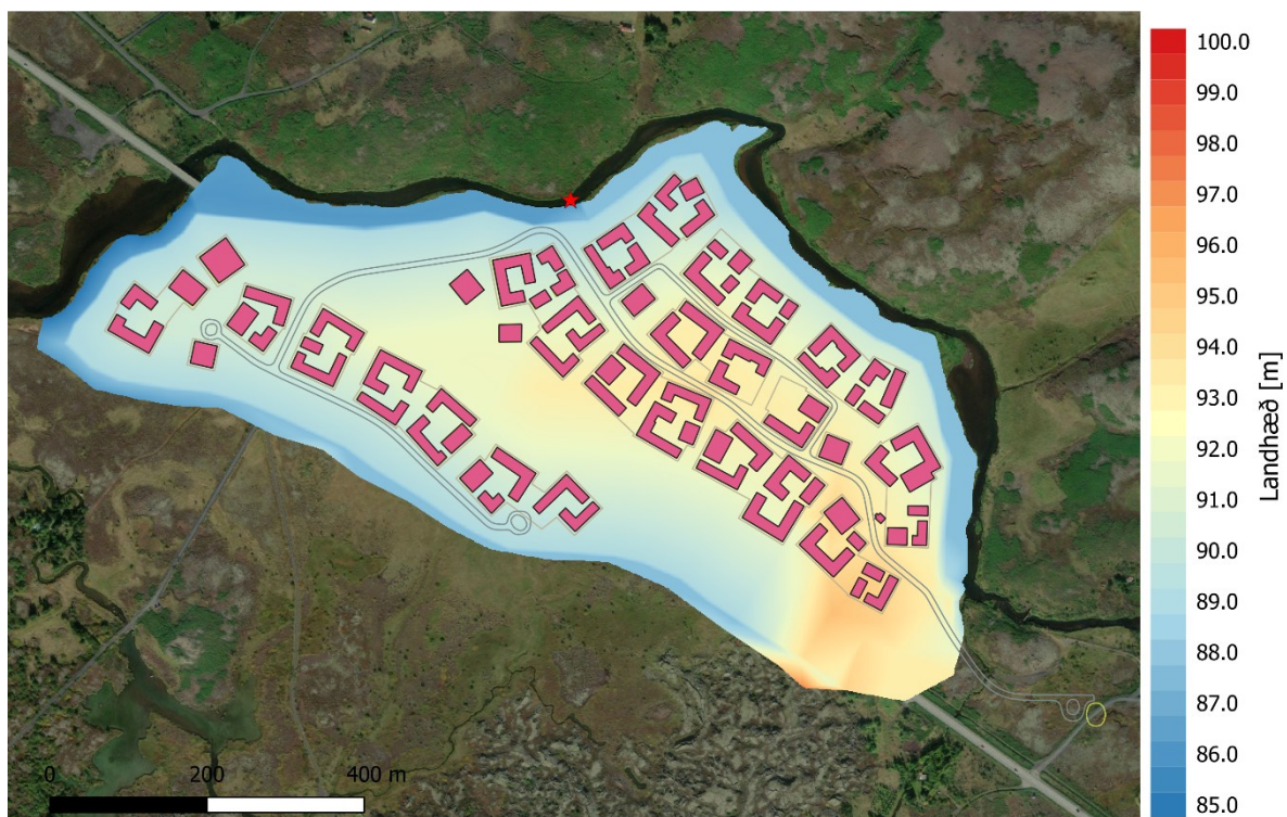
Mynd 9. Hæðarlíkan sem inniheldur skipulagða byggð í Gunnarshólma og mótvægisáðgerðir á bökkum Hólmsár (mynd 15 í Vatnaskil, 2024b).
