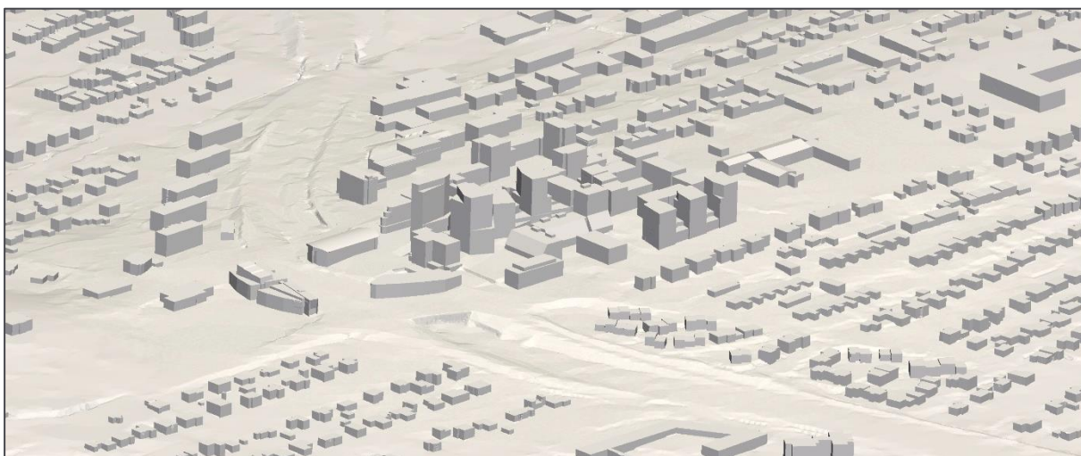
MYND 9 Þrívíddarlíkan af nýja deiliskipulaginu á Fannborgar- og Traðarreit-vestur og núverandi byggingum í kring notað í CFD greiningarnar.
