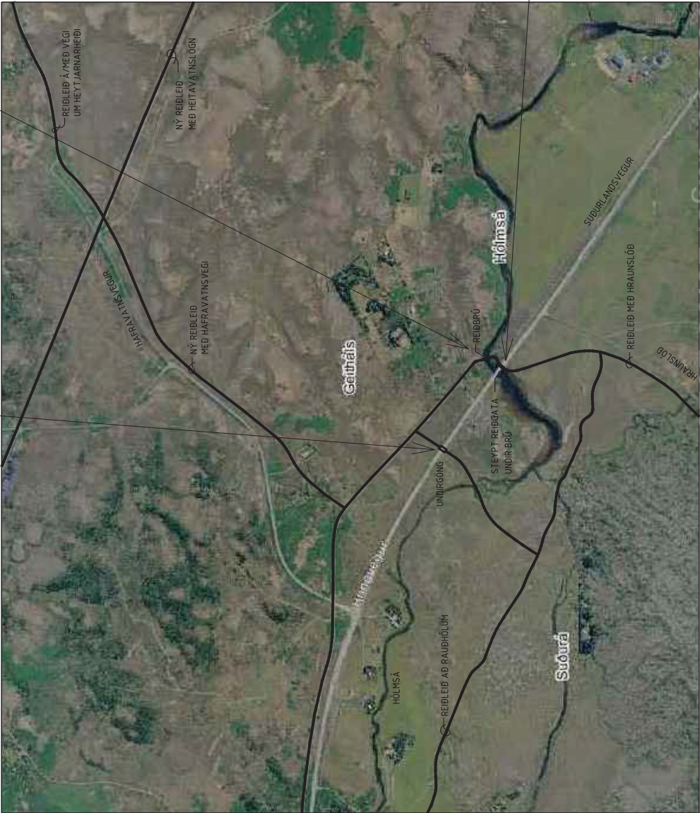
TIL VIBMUNAR REIDGÖNG UNDR SUBURLANDSVEIG NEDAN F JÁRBORGAR. STÆRÐ Á REIDGÖNGUM BREIDD 5.8 m, HÆÐ 4.3 m SANKVÆMT REIDVEGABOK VR OG LH SKAL RYMI Í REIDGÖNGUM VERA MINNST BREIDD 3.0 m OG HÆÐ 3.0 m.
