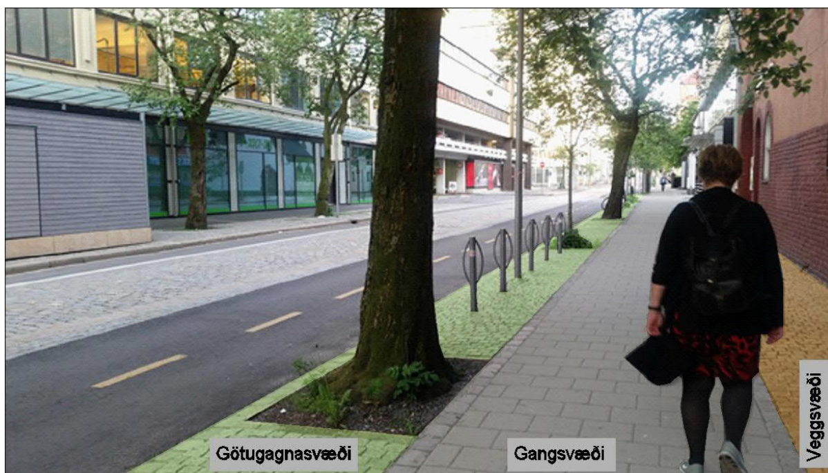
Mynd 4-3 Götugagnasvæði eru höfð utan við gangsvæði og þau aðgreind með ólíku yfirborðsefni, bæði með áferðar- og litamun (Mynd: Áslaug Katrín Aðalsteinsdóttir).
