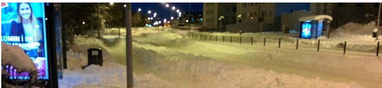
Mynd 5-1 Gangstígur fyrir framan stoppistöðina er ruddur en farþegar sem eru að fara í og úr almenningsvagni eða inn í biðskýli þurfa að fara yfir snjóskafli (Mynd: Berglind Hallgrímsdóttir).
