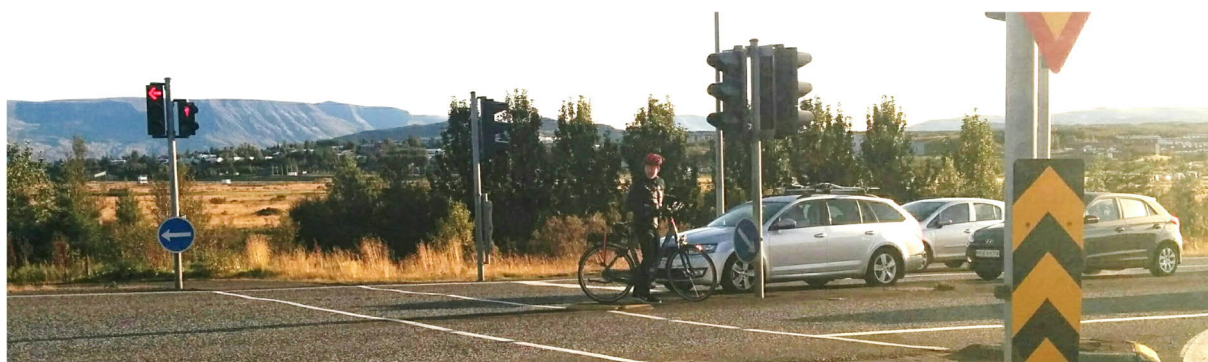
Mynd 4-27 Mikilvægt er að miðeyjur séu nægilega breiðar svo vegfarendur t.d. með hjól eða barnavagn komist þar fyrir. Á myndinni er hjólandi vegfarandi að skjóta afturenda hjólsins til hliðar svo það verði ekki fyrir vinstri beygjumferð. Vegfarandinn náði ekki að þvera alla götuna í einu og miðeyjan er ekki nægilega breið (Mynd: Berglind Hallgrímsdóttir).
