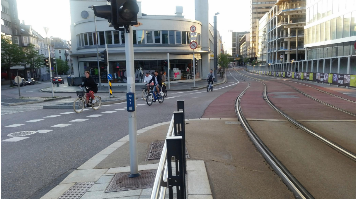
Mynd 6-1 Á myndinni má sjá skilti, gönguljósahnapp með hljóði, umferðarljós, handlista, leiðarlínur, kanta ásamt máluðum upplýsingum á yfirborði gatna (Mynd: Áslaug Katrín Aðalsteinsdóttir).
