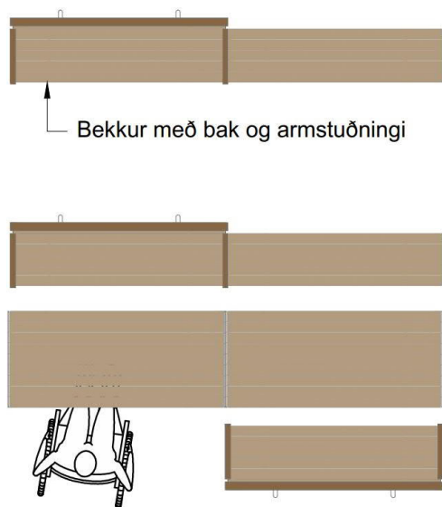
Mynd 4-43 Bekkir með og án bak- og armstuðnings. Nestisbekkir og borð með rými fyrir hjólastól, við hlið á bekk, við langhlið á borði og við borðenda. (Mynd: Áslaug Katrín Aðalsteinsdóttir).
