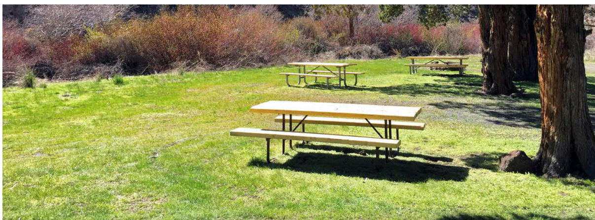
Mynd 4-42 Myndin sýnir bekk með áföstu borði. Á öðrum enda bekkjarins, nær borðbrún lengra út svo þar sé pláss fyrir hjólastól (Mynd: tekin af https://www.flickr.com/photos/blmoregon/28259482946/ ).
