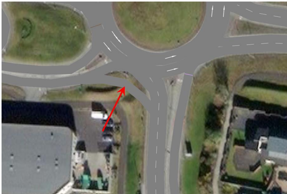
Mynd 7-4 Sviðsmynd 2b, breytingar á hringtorgi á Arnarnesvegi, framhjálaup frá Akraþraut inn á Bæjarþraut
