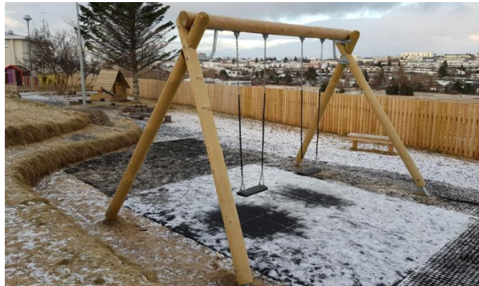
Myndir 12 og 13. Tvö tæki á nýrri lóð leikskólans Álfatúns. Við turn og rennibraut er 30cm þykk öryggismöl (2-8mm) og við rólu eru annars vegar gúmmíhellur og gúmmímottur á grasi til beggja enda. Allar mælingar stóðust kröfur um falldempun.
