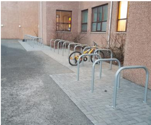
Myndir 10 og 11. Hjólastæði við Smáraskóla. Þau sem eru á mynd 11 fara ekki aðeins verr með hjólin heldur hafa þau einnig valdið slysum. Hraða þyrfti útskiptum á slíkum hjólagrindum og setja hjólaboga, eins og á mynd 10, eða sambærilegt í staðinn.
