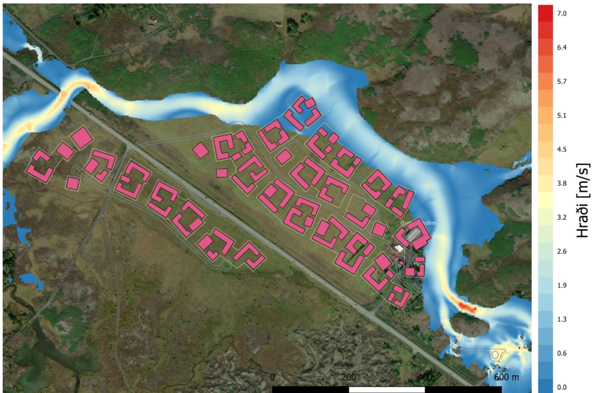
Mynd 13. Straumhraði í flóðum í Hólmsá við Gunnarshólma m.v. fyrstu útgáfu hæðarsetningar skipulags og 100 ára flóð.
