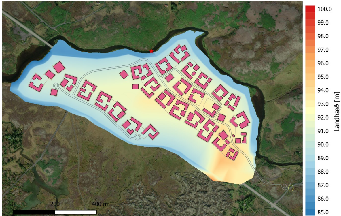
Mynd 15. Hæðarlíkan sem inniheldur skipulagða byggð í Gunnarshólma og mótvægisáðgerðir á bökkum Hólmsár.
