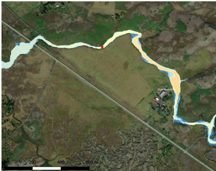
Mynd 8. Útbreiðsla og dýpi árlegra flóða (efri mynd) og flóða með 10 ára endurkomutíma (neðri mynd) í Hólmsá við Gunnarshólma.
