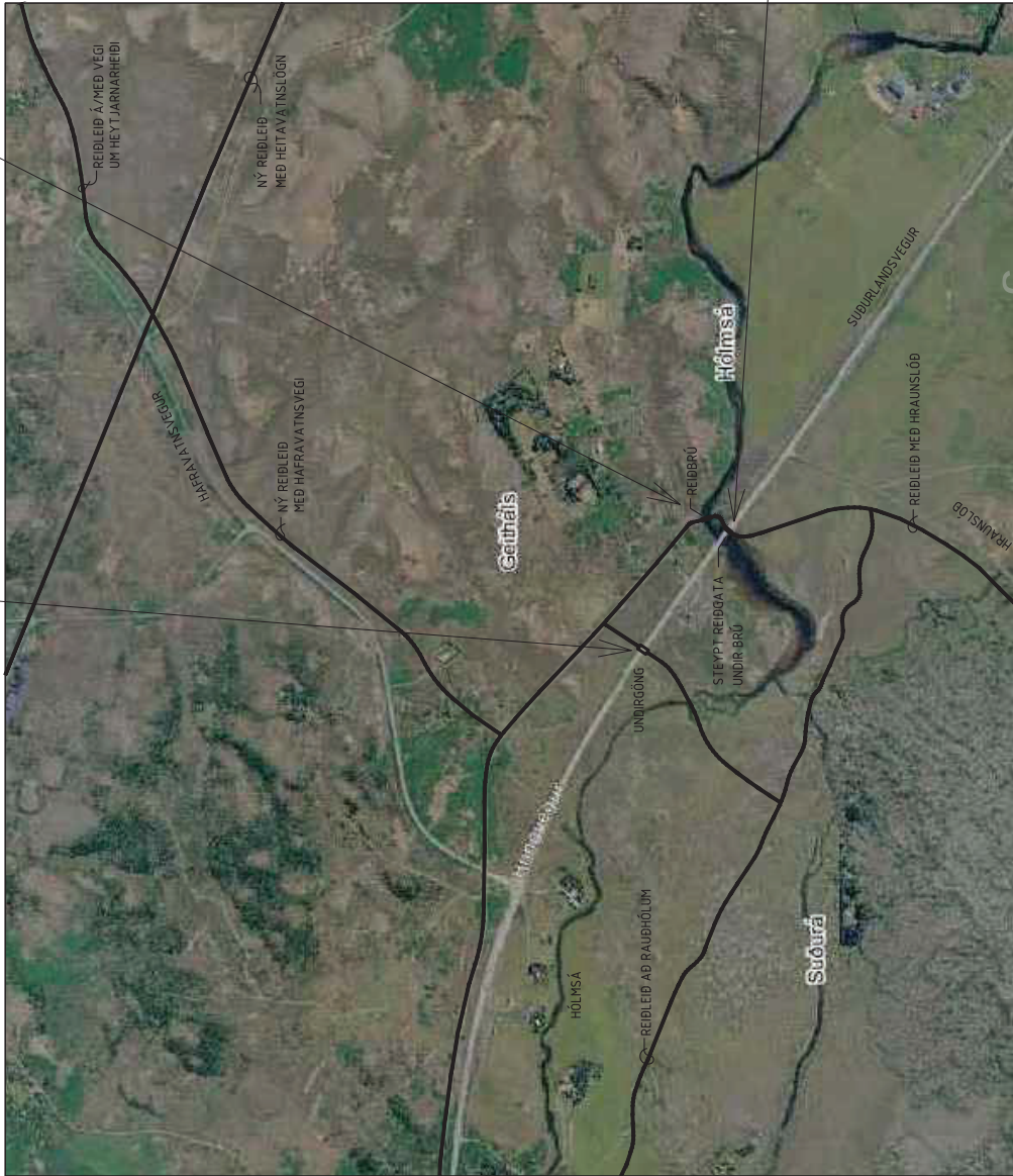
TIL VINDMUNAR REIDGÖNG UNDR SUBURLANDSVEIG NEDAN F JÁRBORGAR. STÆRÐ Á REIDGÖNGUM BREIDD 5.8 m, HÆÐ 4.3 m SANKVÆMT REIDVEGABOK VR OG LH SKAL RYMI Í REIDGÖNGUM VERA MINNST BREIDD 3.0 m OG HÆÐ 3.0 m.
