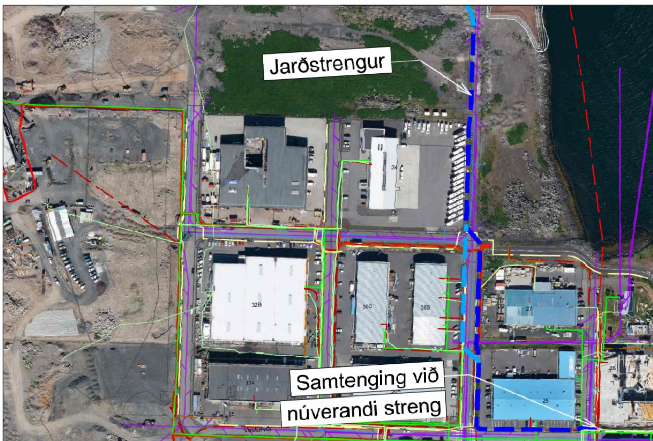
Skýringarmynd. Loftmynd með fyrirhugaðri legu nýs jarðstrengjar.
